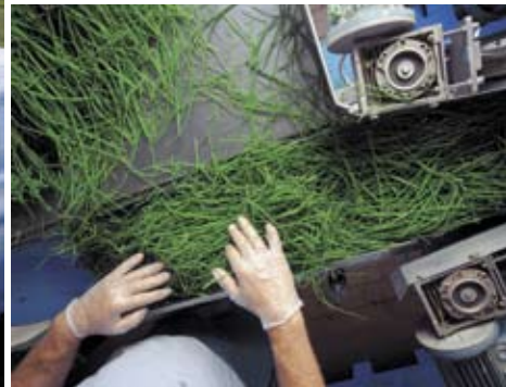
Im ersten Verarbeitungsprozess wird der Schnittlauch bereitgelegt, sortiert und geschnitten, ehe er in der wichtigsten Maschine der SAH mittels Vakuummethode getrocknet wird.
