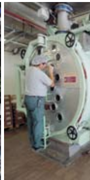
Im ersten Verarbeitungsprozess wird der Schnittlauch bereitgelegt, sortiert und geschnitten, ehe er in der wichtigsten Maschine der SAH mittels Vakuummethode getrocknet wird.
